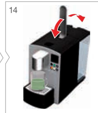
Hebel öffnen, Reinigungskapsel auswerfen und Hebel wieder schließen.
