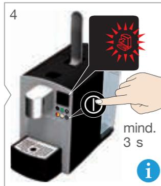
4 Kapselzähler zurücksetzen: Ein/Aus-Taste mindestens 3s lang drücken.
