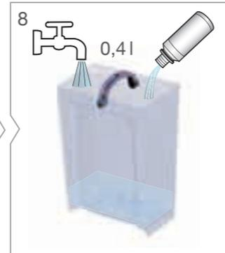
Entkalkungsmittel (100 ml) und 0,4l Wasser in Wassertank füllen.
