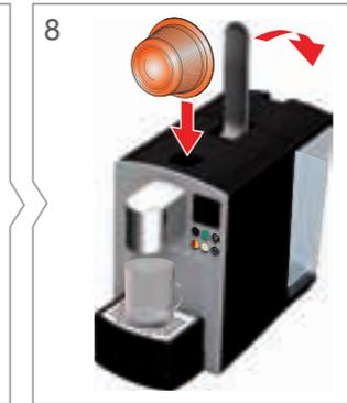
8 Hebel öffnen, Reinigungs-kapsel einlegen und Hebel wieder schließen.
