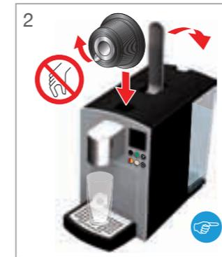
2 Falls vorhanden, Bodenlasche abziehen. Hebel öffnen und Kapsel einlegen.
