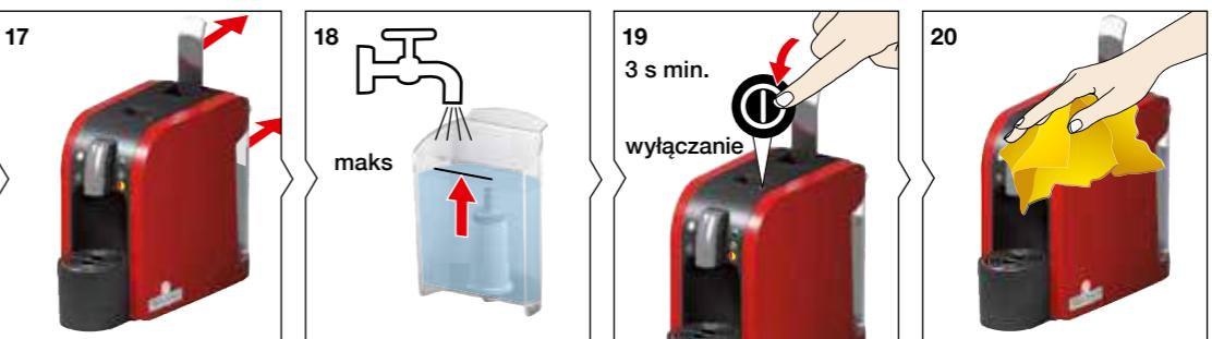
**PL CZYSZCZENIE URZĄDZENIA ZA POMOCĄ KAPSŁA CZYSZCZĄCEGO (ciąg dalszy)**
