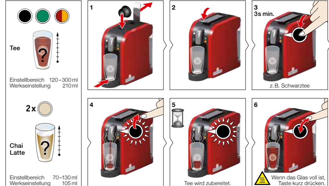
Beim Tee wird durch die Programmierung die Füllmenge des letzten Brühintervalls verändert, nicht aber die Brühpause(n). Die neuen Füllmengen bleiben gespeichert (auch nach einer Netzunterbrechung). Es ist möglich, die Tassenfüllmengen auf die Werkseinstellungen zurückzusetzen. Lesen Sie hierzu die häufig gestellten Fragen auf Seite 19.
